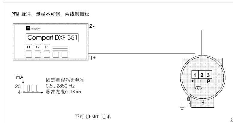
Fig. 14 PFM 脉冲, 量程不可调, 两线 制接线
